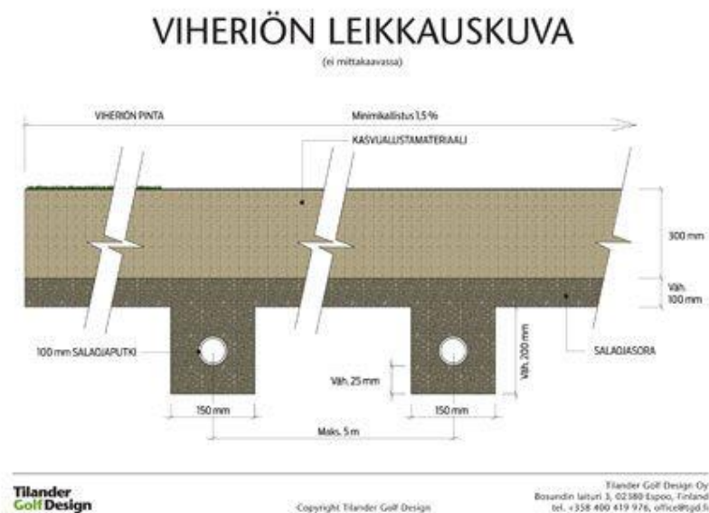
Kuva 1. Poikkileikkauskuva viheriön rakenteesta. (Jokinen Jari, 2012)
