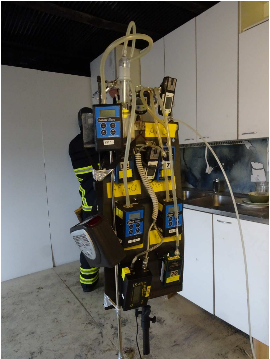
Kuva 4. Keräävät mittalaitteet asennettuna palotilaan. Mittalaitteet suojattiin koepolton ajaksi sammutustakilla.
