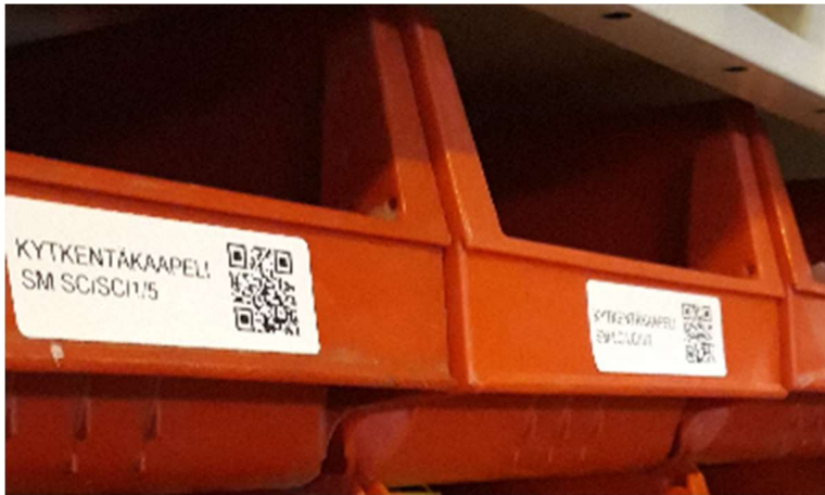
Kuva 6. Hyllytettujen nimikkeiden merkitseminen QR-koodilla
