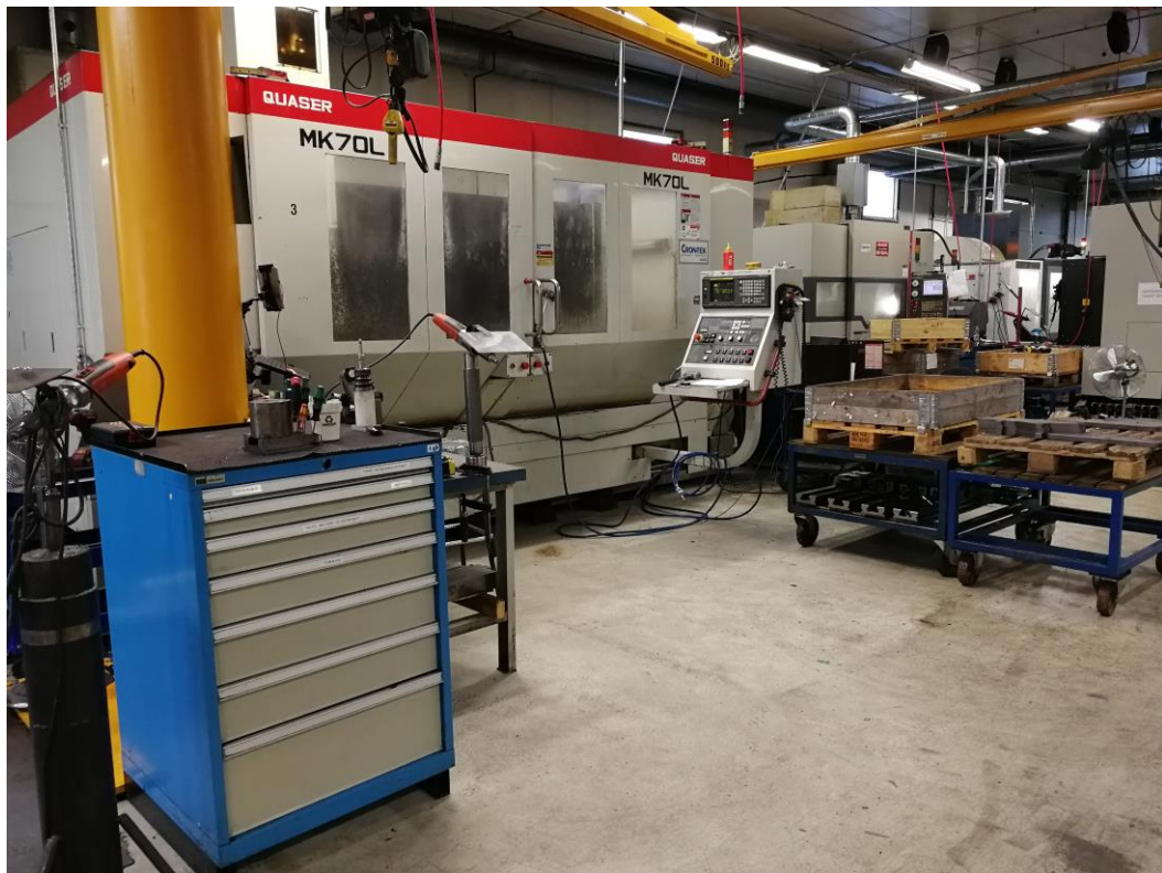
Kuva 8. Quaser MK70L -työstökeskus.
