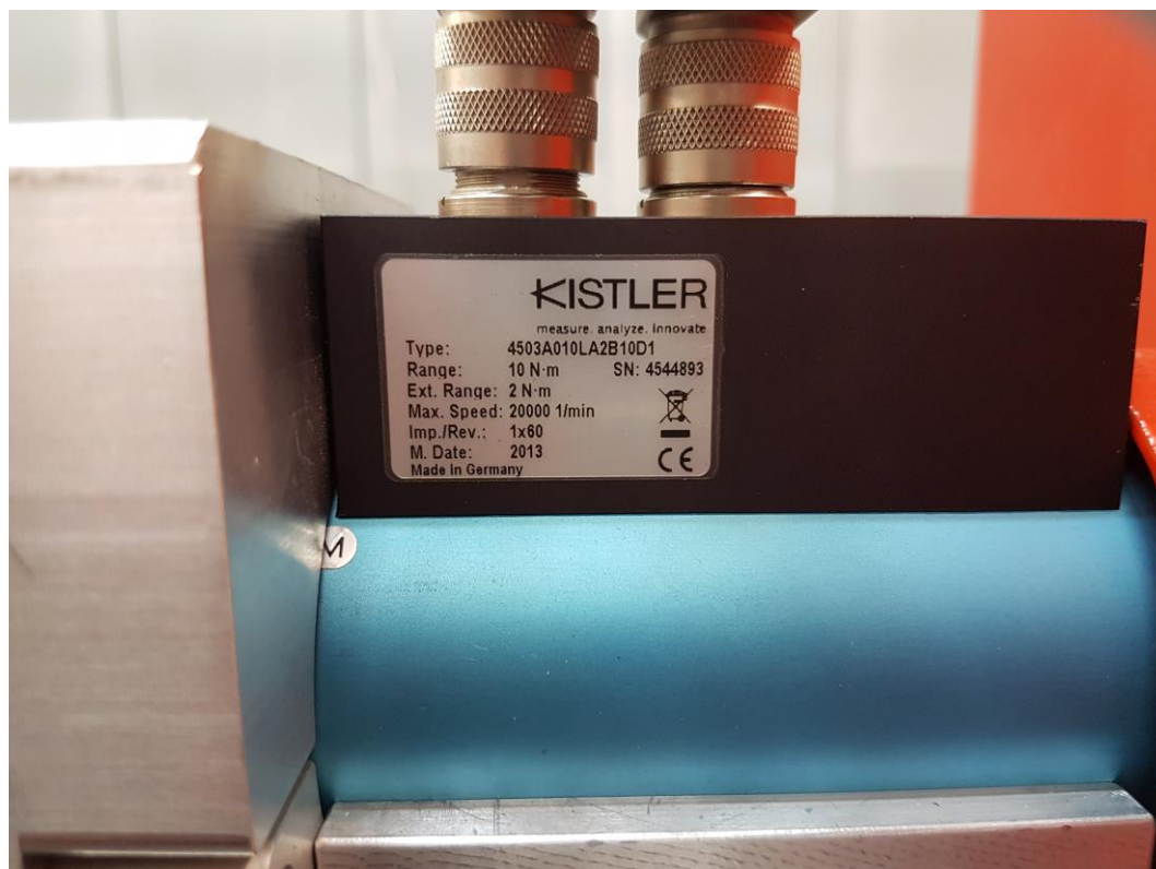
Kuva 10. Kistler Dual Range 4503A-momenttianturi
