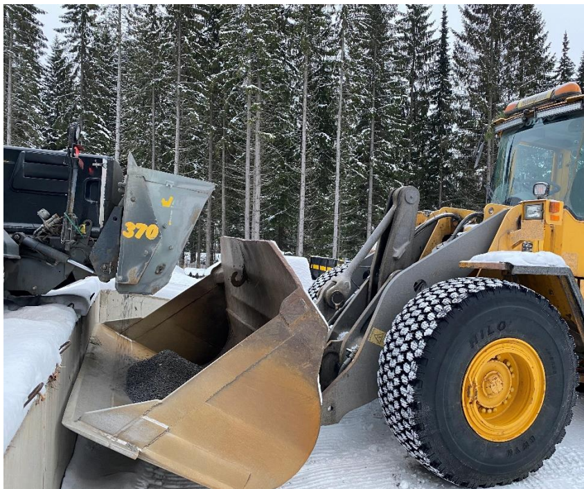
Kuva 15. Täyden hiekoittimen tyhjennys kauhaan, hiekoittimen kapasiteetin mittausta varten (Janhunen 2020)
