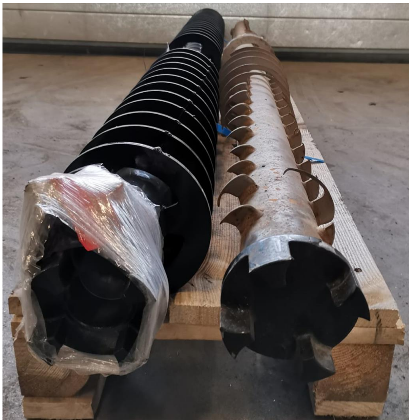
Kuva 17. Tokvam TSA 2100 hiekoittimen uusi ja loppuun kulunut syöttöakseli (Matilainen 2020)
