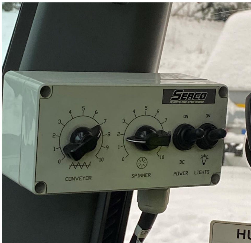
Kuva 14. Serco-lautashiekoittimen ohjainlaite, josta sirotusmäärä merkinnät vielä puuttuvat (Janhunen 2020)
