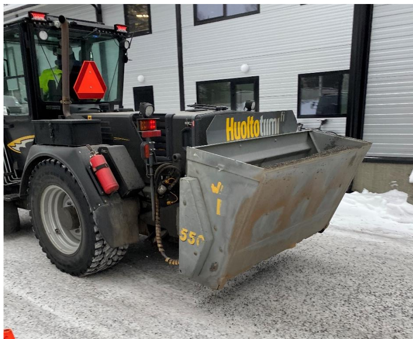
Kuva 5. Alle sirottava hiekoitin (Janhunen 2020)
