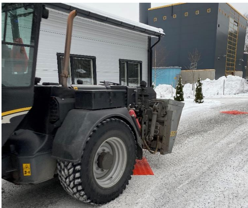
Kuva 9. Alle sirottavan hiekoittimen mittausajo (Janhunen 2020)
