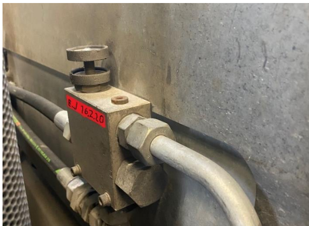
Kuva 12. Lukittu säätö ja säätöpäivä merkittynä (Janhunen 2020)
