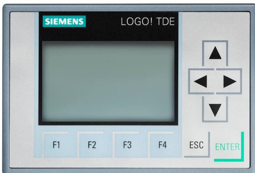
Figur 12 Bildenheten TDE som monterades i hytten på maskinen [13].
