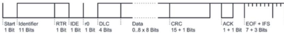
Figur 6 Innehållet i ett CAN meddelande [7, p. 5].
