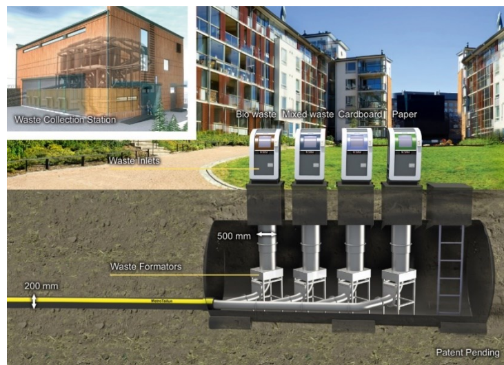
Kuva 10. Jätteen putkikeräysjärjestelmän läpileikkaus (MariMatic Oy, 2011).
