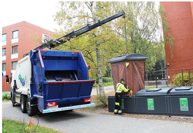
Kuva 9. Syväkeräysastian tyhjentäminen nosturilla (Molok, n.d.b).
