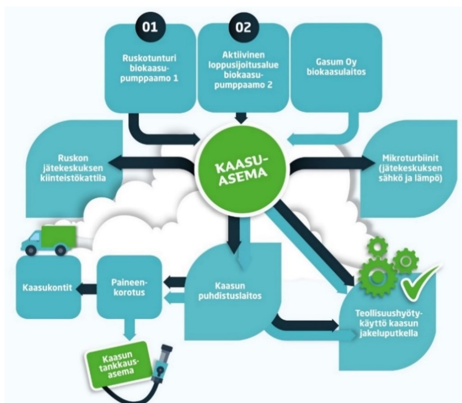
Kuva 5. Kiertokaaren biokaasujärjestelmä (Kiertokaari, 2017a).
