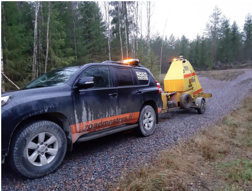
KUVA 2. Auton perässä vedettävä pudotuspainolaite (2018)
