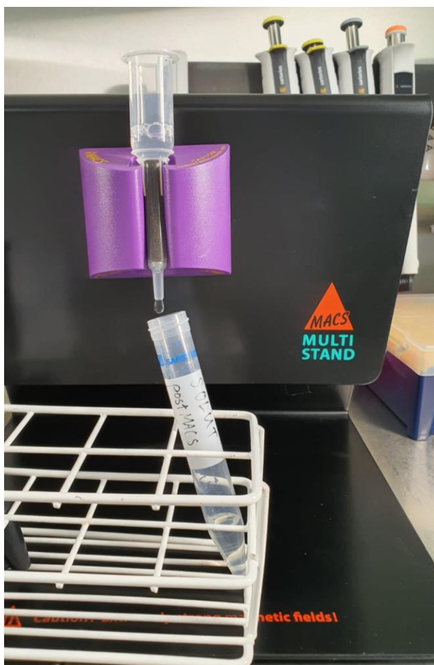
KUVA 5. Magneettierottelu käyttäen MACS®-magneettirikastinta
