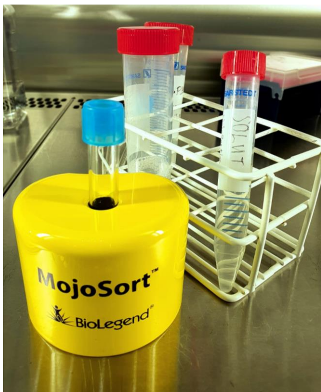
KUVA 4. Magneettierottelu käyttäen MojoSort™-magneettirikastinta
