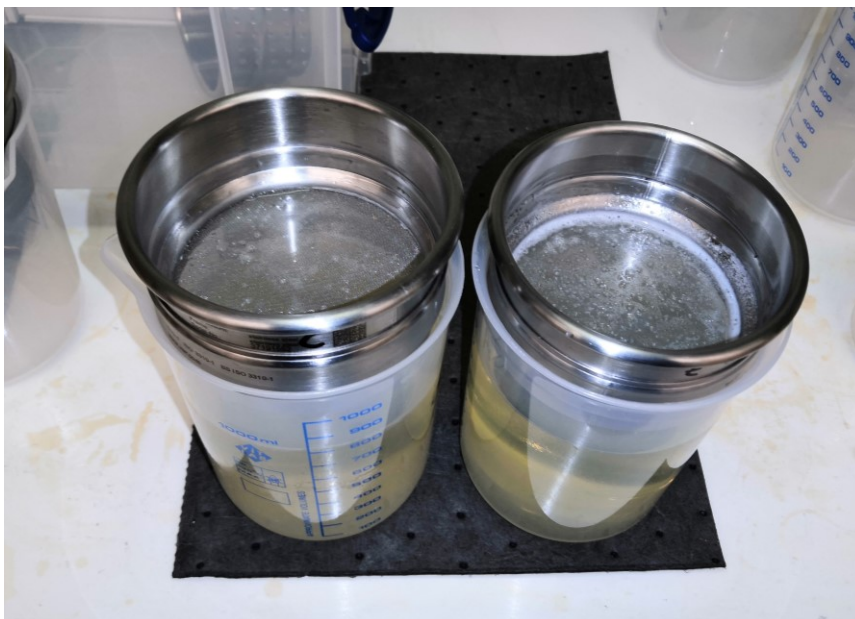
KUVA 2. Geeliä seuloilla PAE-liuoksen suodatuksen jälkeen.
