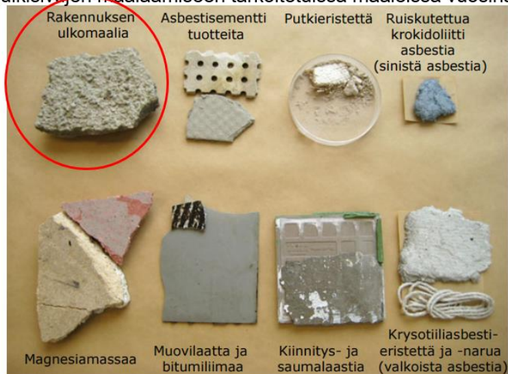
Kuva 7. Asbestia sisältäviä vanhoja rakennusmateriaaleja. [3, s. 11]
