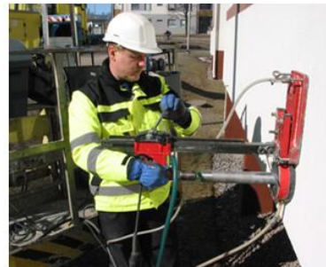
Kuva 20. Karbonatisoitumissyvyyden mittaaminen rakenteesta ja näytteestä. [3, s. 24.]
