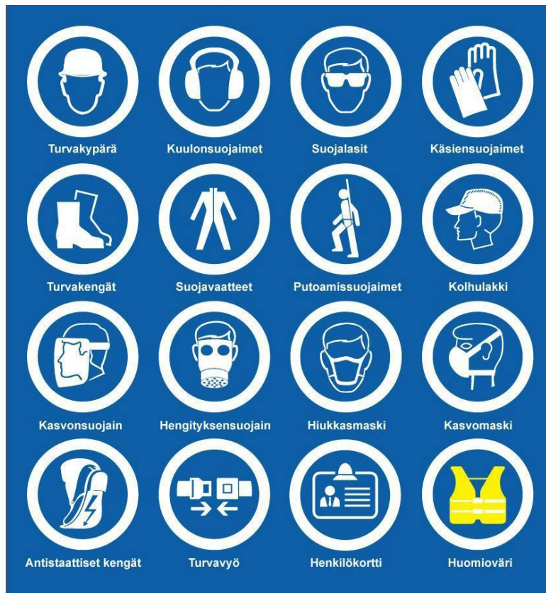
Kuvio 4. Esimerkkikuvioita mitä henkilökohtaisia varusteita tai toimenpiteitä työmaalla saatetaan vaatia. Yleisimmät pakolliset vaatimukset ovat turvakypärä, kuulonsuojaimet, suojalasit, turvakengät naula- ja kärkisuojalla, huomiovärilliset vaatteet ja henkilökortti.
