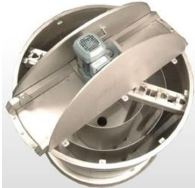
Kuva 5. Pyörivä lämmöntalteenottolaite likaiselle nesteelle suuriin kiinteistöihin (Termihaukka)
