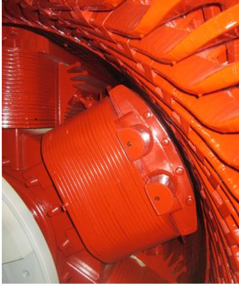
Kuva 15. Kuva roottorista staattorin sisällä. Kuvassa näkyy napojen välissä olevat käämituet ja navan päätyjä tukevat kaksi tukitankoa. Roottori ja staattori on pinnoitettu punaisella epoksihartsilla.
