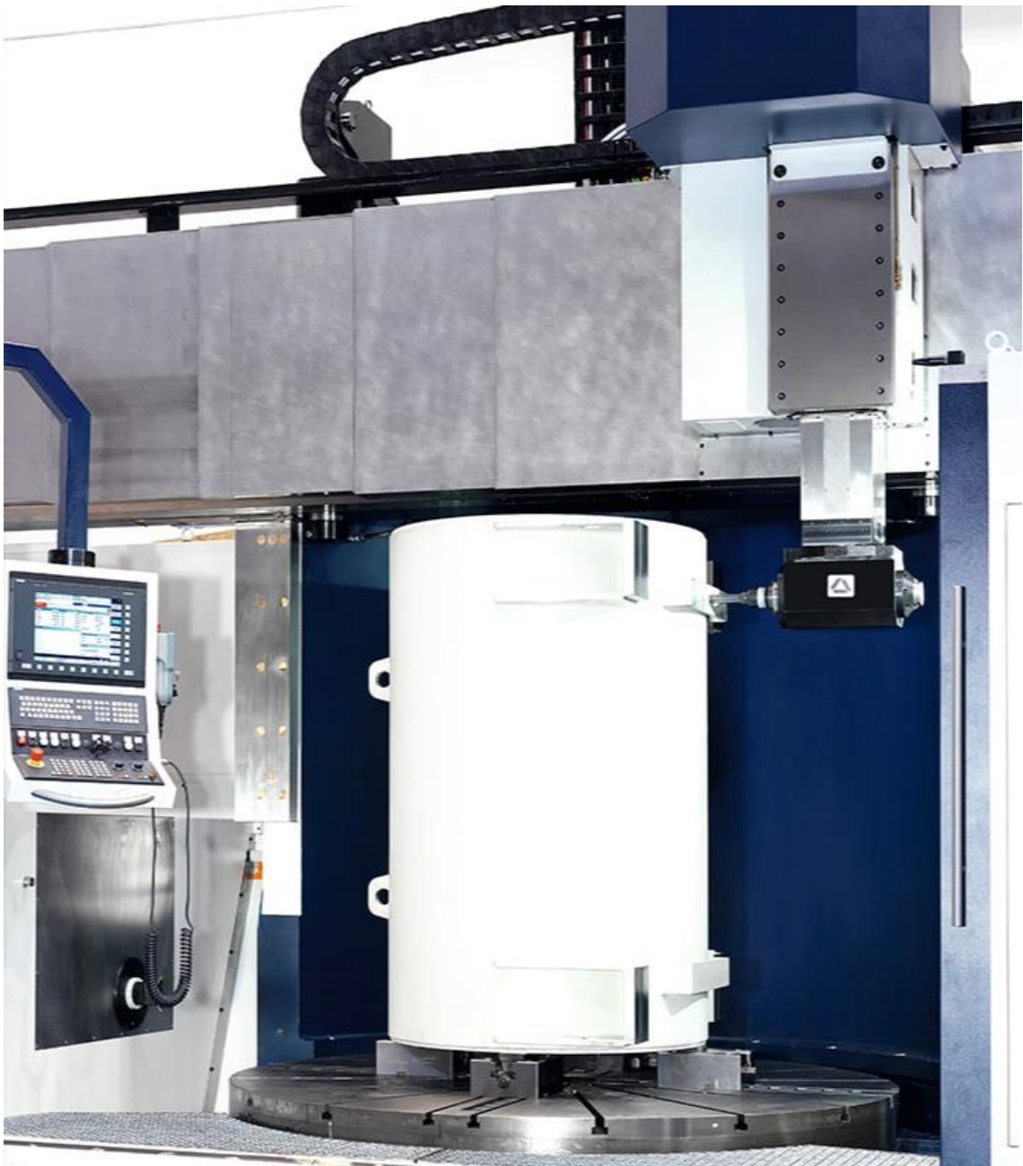
Kuva 1. Pyörivillä työkaluilla varustettu pystysorvi. Sorvin karalla on kulmapää, joka mahdollistaa työstämisen kappaleen säteen suunnassa (Soraluce 2020: 13).
