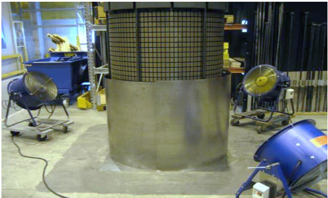
Kuva 10. Hallittu jäähdytysprosessi sovellettuna induktiokoneen roottoriin. Kuvassa näkyy ainoastaan napalevypaketti. Napalevypaketti on eristetty alaosasta ja sen yläosaa jäähdytetään kolmella puhaltimella. (Patwardhan ym. 2013.)
