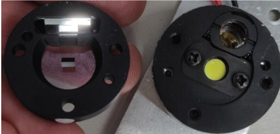
Kuva 7. Prototyyppi 1. -laserlisävalon laseryksikkö (oik.) ilman säteenohjauspeilejä (vas.).
