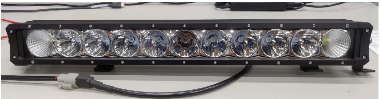
Kuva 8. Prototyyppi 2. -laserlisävalomoduli, jossa keskellä SMD-laseryksikkö ja reunoilla 2 x 5 kpl teholedejä.
