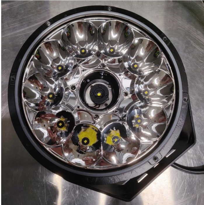
Kuva 5. Prototyyppi 1. -lisävalokonstruktio, jossa reunoilla 8 kpl teholedettä ja keskellä laseryksikkö ilman lisävalon linssiä.
