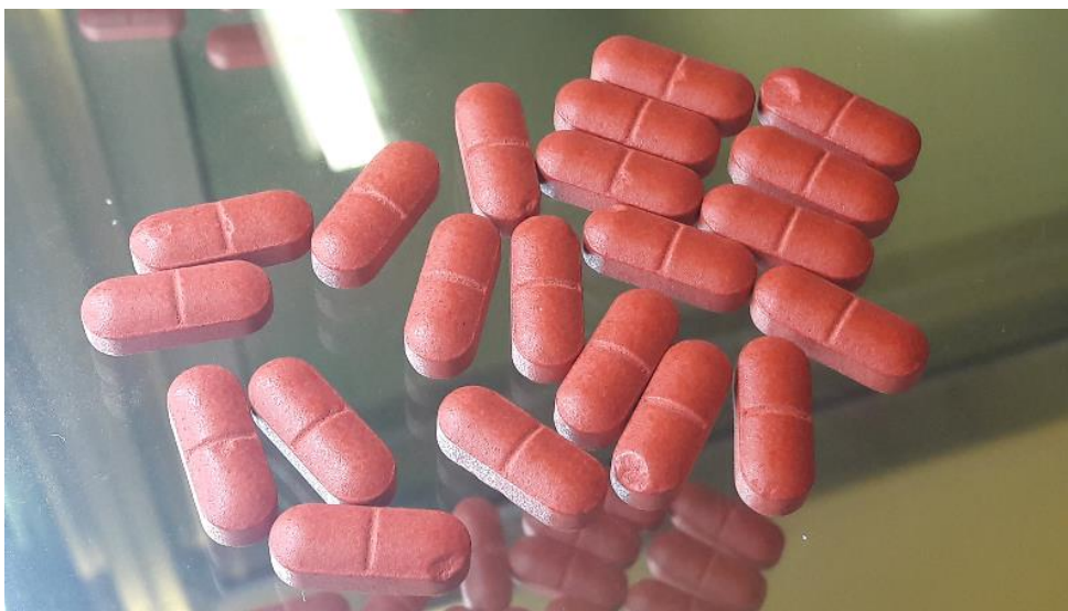
Kuva 18. Tuote A, tuotantomittakaavan koe-erässä havaittuja lohkeamia tableteissa.
