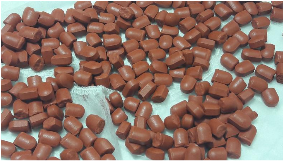
Kuva 17. Tuote A, tuotantomittakaavan koe-erässä rikkoutuneita tabletteja.
