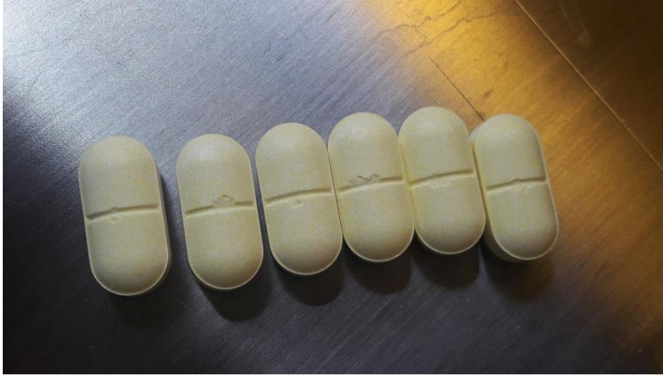
Kuva 21. Esimerkki tabletin tarttumasta painimiin.
