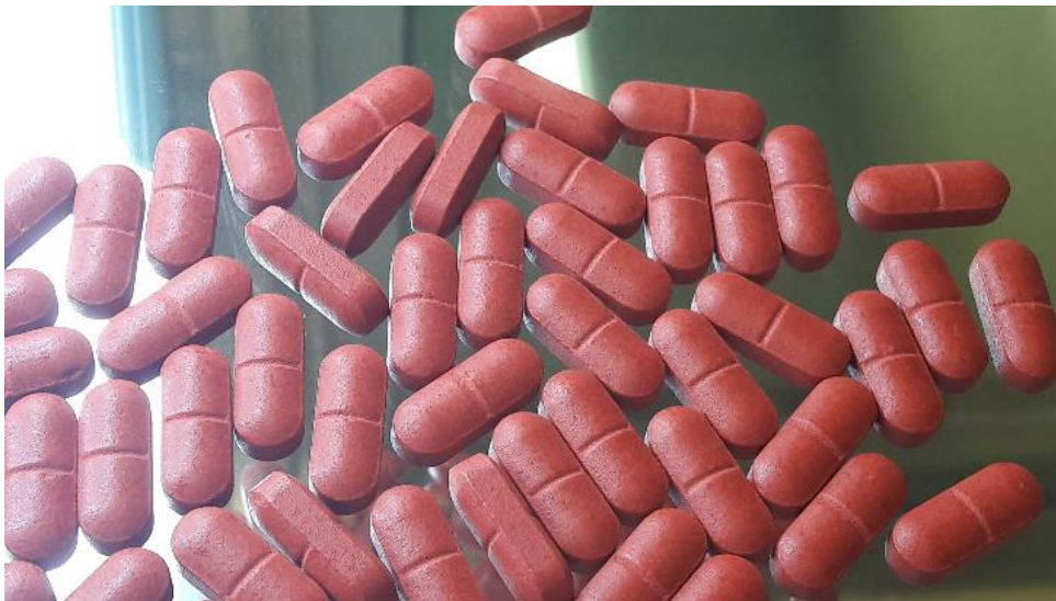
Kuva 19. Tuote A, tuotantomittakaavan koe-erässä havaittuja tarttuvia tableteissa.
