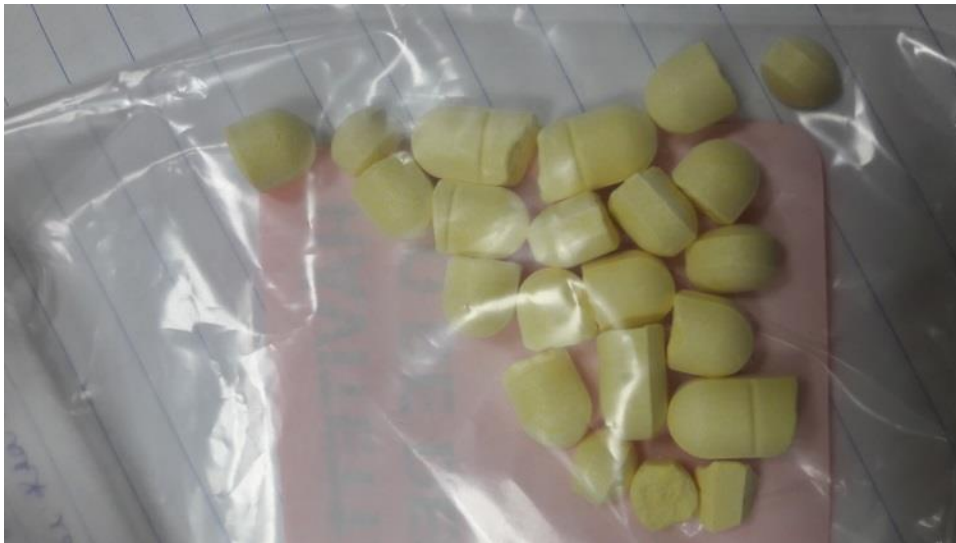
Kuva 20. Tuote B, tuotantomittakaavan koe-erässä rikkoutuneita tabletteja.
