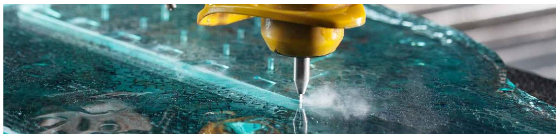
Kuva 22. Flow waterjet. (Cutting glass with waterjet, 2020)
