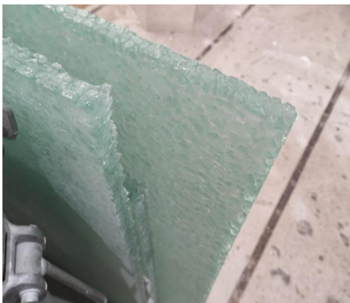
Kuva 8. Sulatettua lasimurskaa. (LARRONMAA, 2020)
