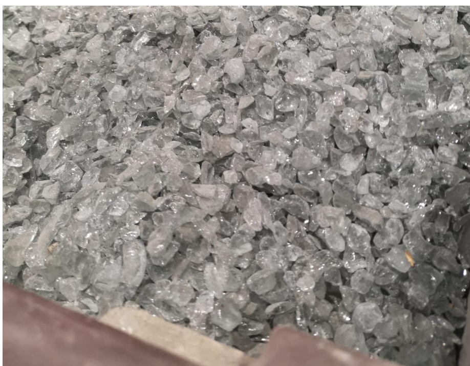
Kuva 6. Ylijäämälasia murskauksen jälkeen. (LARRONMAA, 2020)
