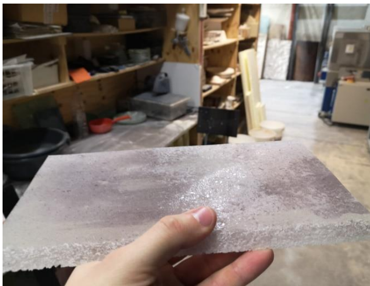
Kuva 7. Sulatettua lasijauhetta. (LARRONMAA, 2020)
