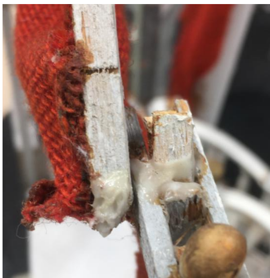
Kuvat verhokapan liitoskohdasta ennen liiman poistoa ja liimauksen jälkeen.
