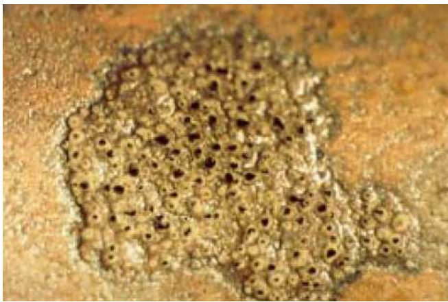
Kuva 7. Mikrobiologisen toiminnan aiheuttama korroosio. Putken pinta on puhdistettu hapolla ennen valokuvan ottoa. (Oliphant & Jönsson 2010: 16.)
