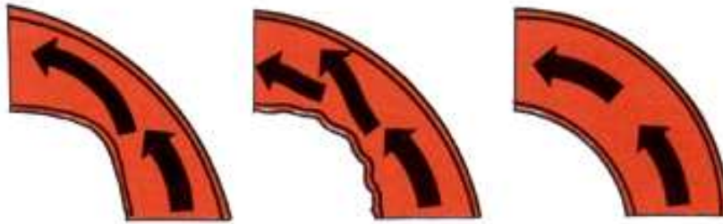
Kuva 5. Kupariputken huonossa taivutuksessa litistynyt putki (vasemmalla), poimuttunut putki (keskellä) sekä hyvin tehty putkitaivutus (oikealla) (Kupari.com).
