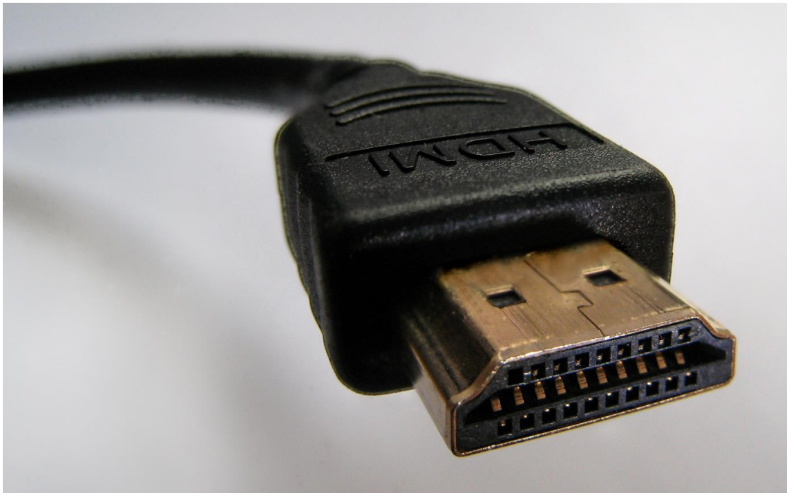
Kuva 5. HDMI-kaapeli ja urosliitin [10].
