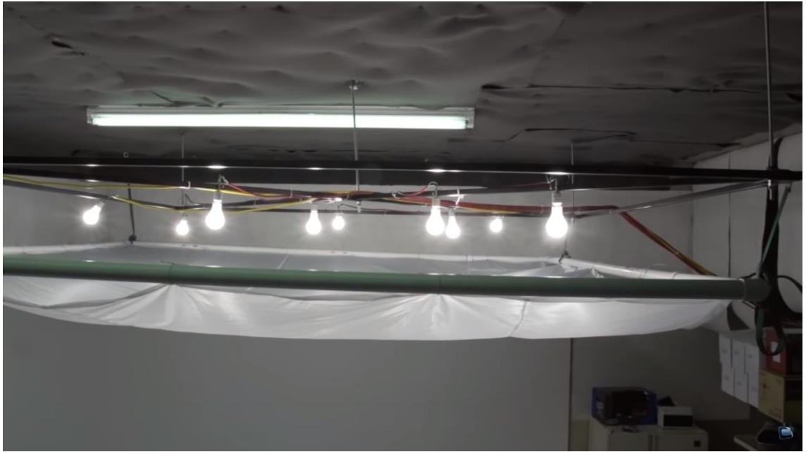
Kuva 12. Hehkulampuista rakennettu matriisi ja hajotinkangas kattotelineissä [23].
