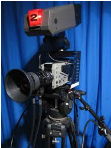
Kuva 9. Merkkivalo kameran päällä kertoo kameran kuvan olevan nyt lähetyksessä [18].
