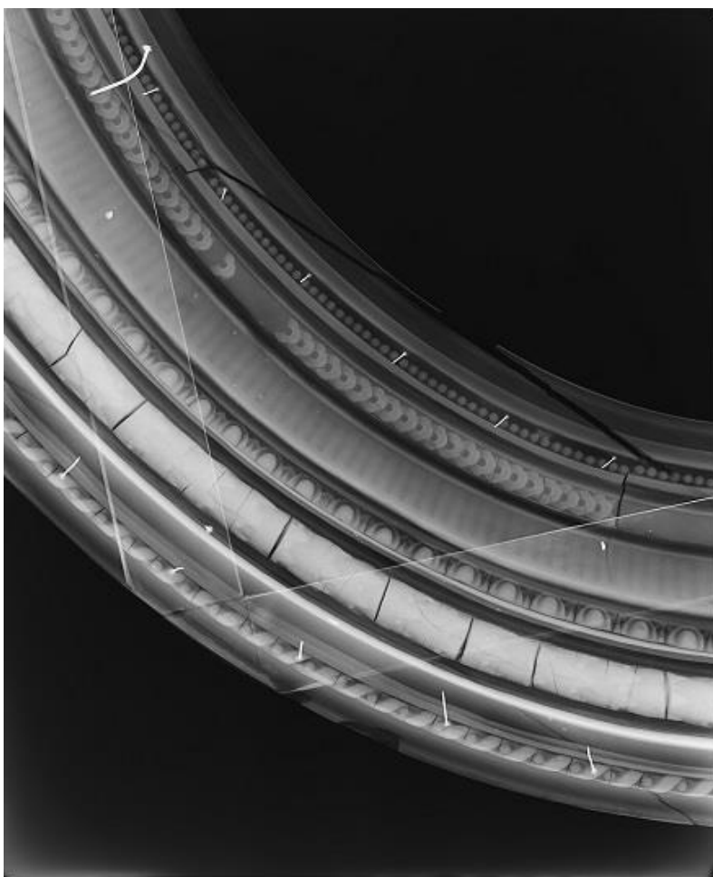
Kuva 13. Röntgenkuva kehyksen rakenteesta.
