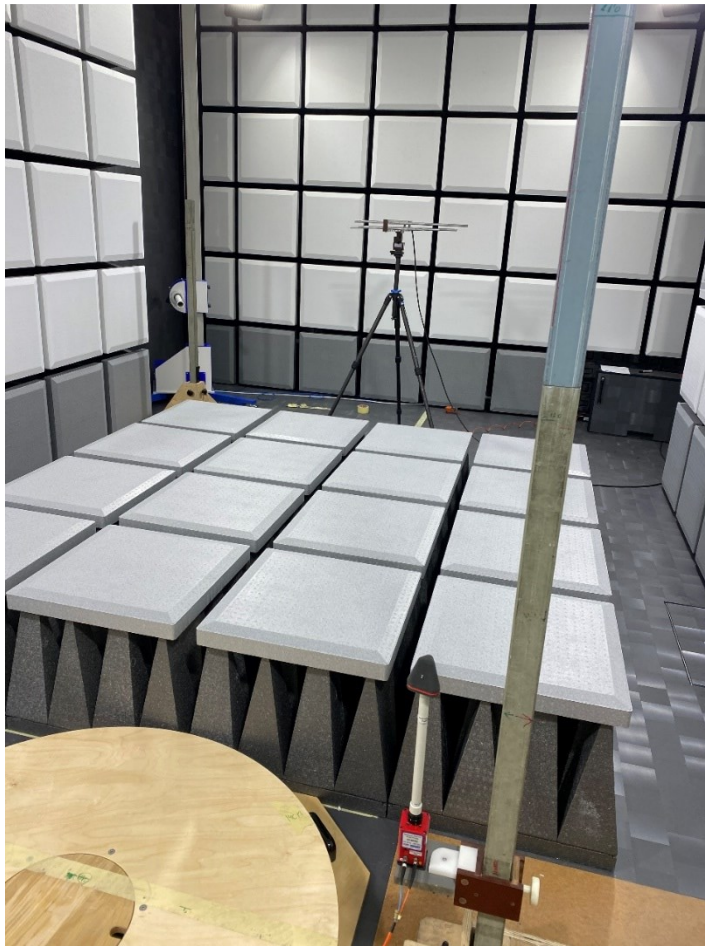
Kuvio 23. Sähkömagneettikentän yhdenmukaisuusmittauksien asetelma
