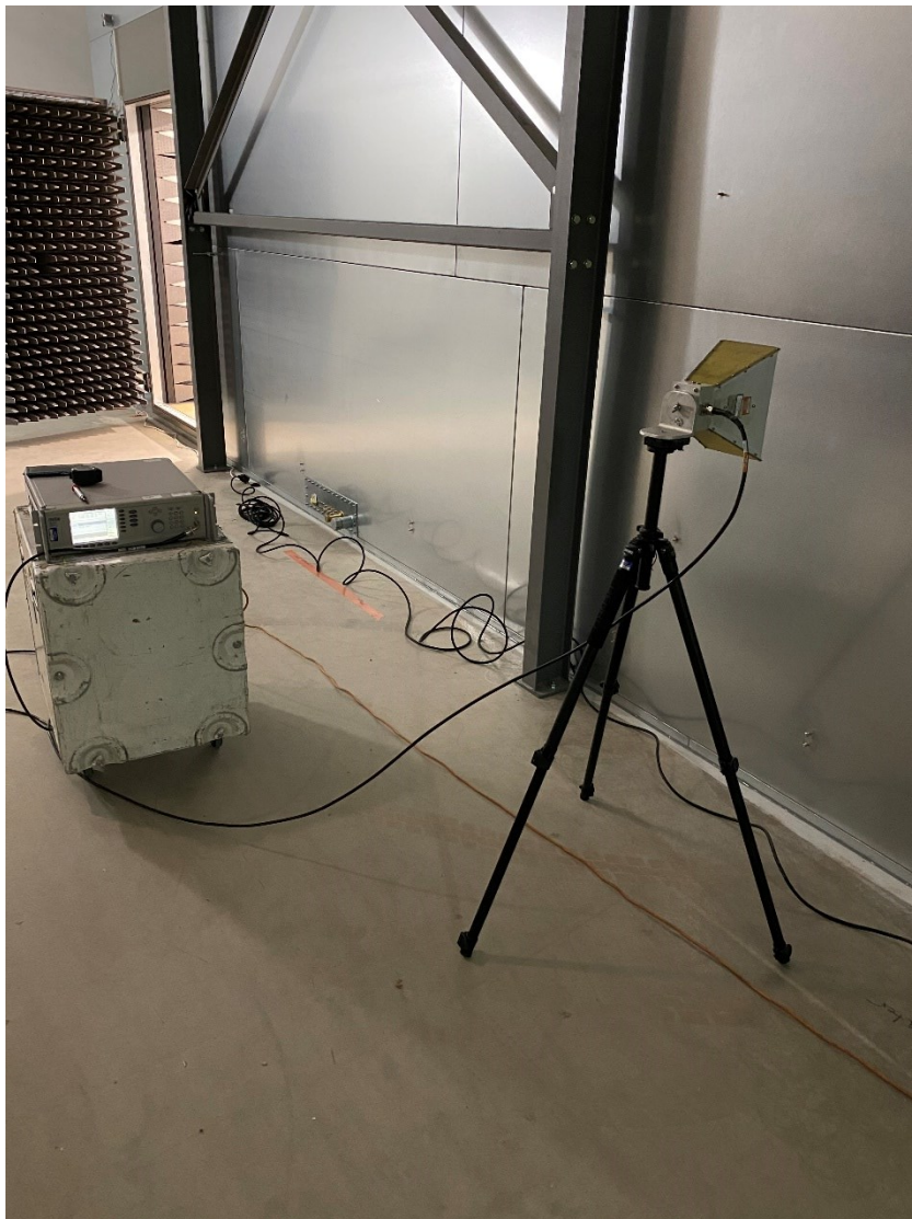
Kuvio 19. Suojausvaimennusmittauksien mittausasetelma
