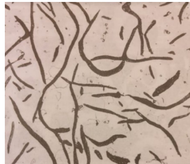
Kuva 2. Somu- ja pallografiittirauta. (Ihalainen 1985, 69-70.)
