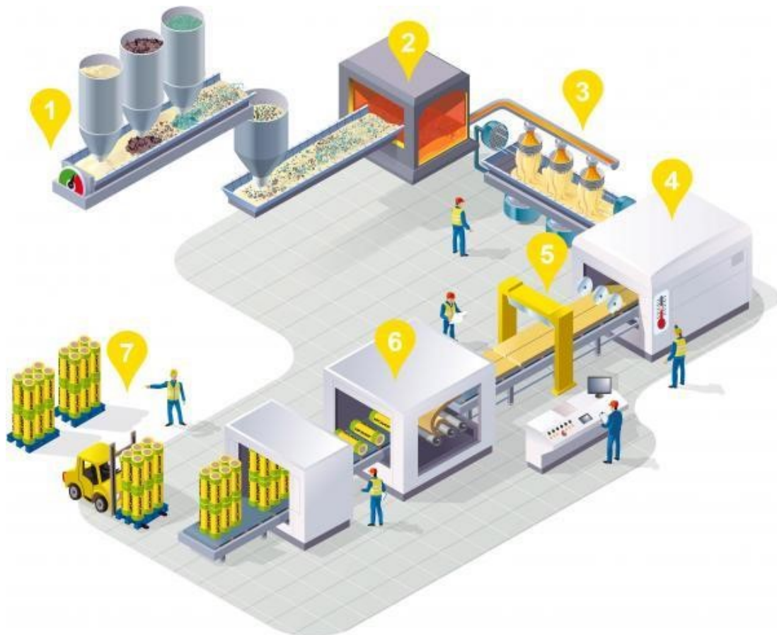
Kuva 1. Seitsemän vaihetta lasivillan valmistuksessa (Isoverin www-sivut 2020.)
