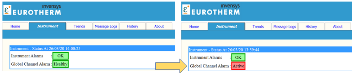
Kuva 14 Hälytyksen lähdön testaus Eurotherm-dataloggerilta.
