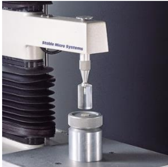
Kuva 13. Chen-Hoseney Dough Stickiness Rig taikinan tarttuvuuden tutkimiseen. (Smewing 2015a).
