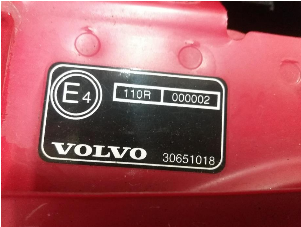
Kuva 2. Esimerkki koko ajoneuvoa koskevasta E-hyväksynnästä (Ajoneuvon CNG-järjestelmä) Hyväksyjävaltio Alankomaat, hyväksytty säännön 110 mukaisesti. Hyväksyntänumero 2.
