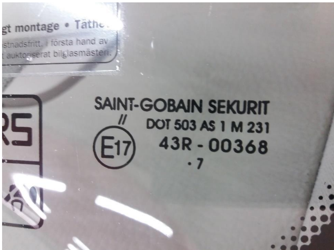
Kuva 1. Esimerkki varusteen (tuulilasi) E-hyväksyntämerkinästä. Hyväksyjävaltio: Suomi, hyväksytty säännön 43 mukaisesti, hyväksyntänumero 365.
