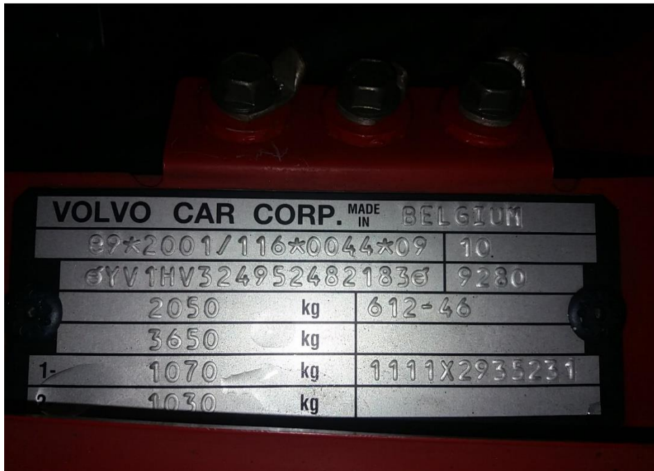
Kuva 4. Esimerkki koko ajoneuvon EY-tyyppihyväksyntämerkinnästä (M1-luokan ajoneuvo). Hyväksyjävaltio Espanja. Hyväksytty direktiivin 2001/116 nojalla.
