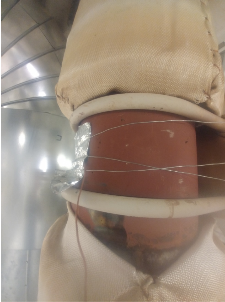
Figur 11. Infästning av termoelement vid temperaturmätning av ingående vatten till system 2. Även rörisolering återmonterades för att säkerställa goda mätresultat.
