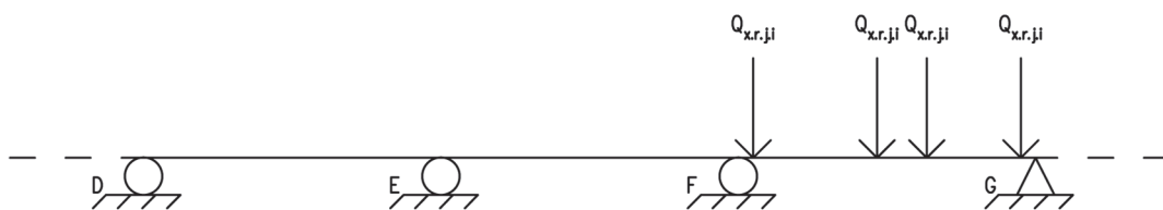
Figur 25. Fall 4, ger största tvärkraft- och fältmomentfördelning.
