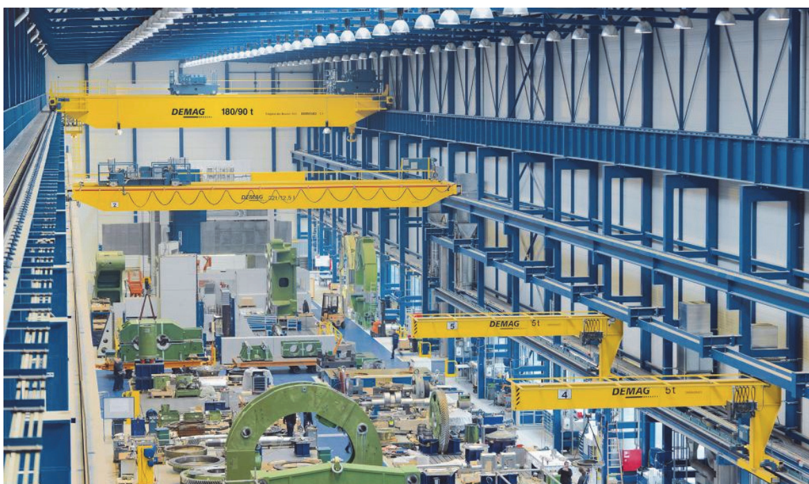
Figur 1 Multipla rälgående traverskranar i flera våningar. [5]
