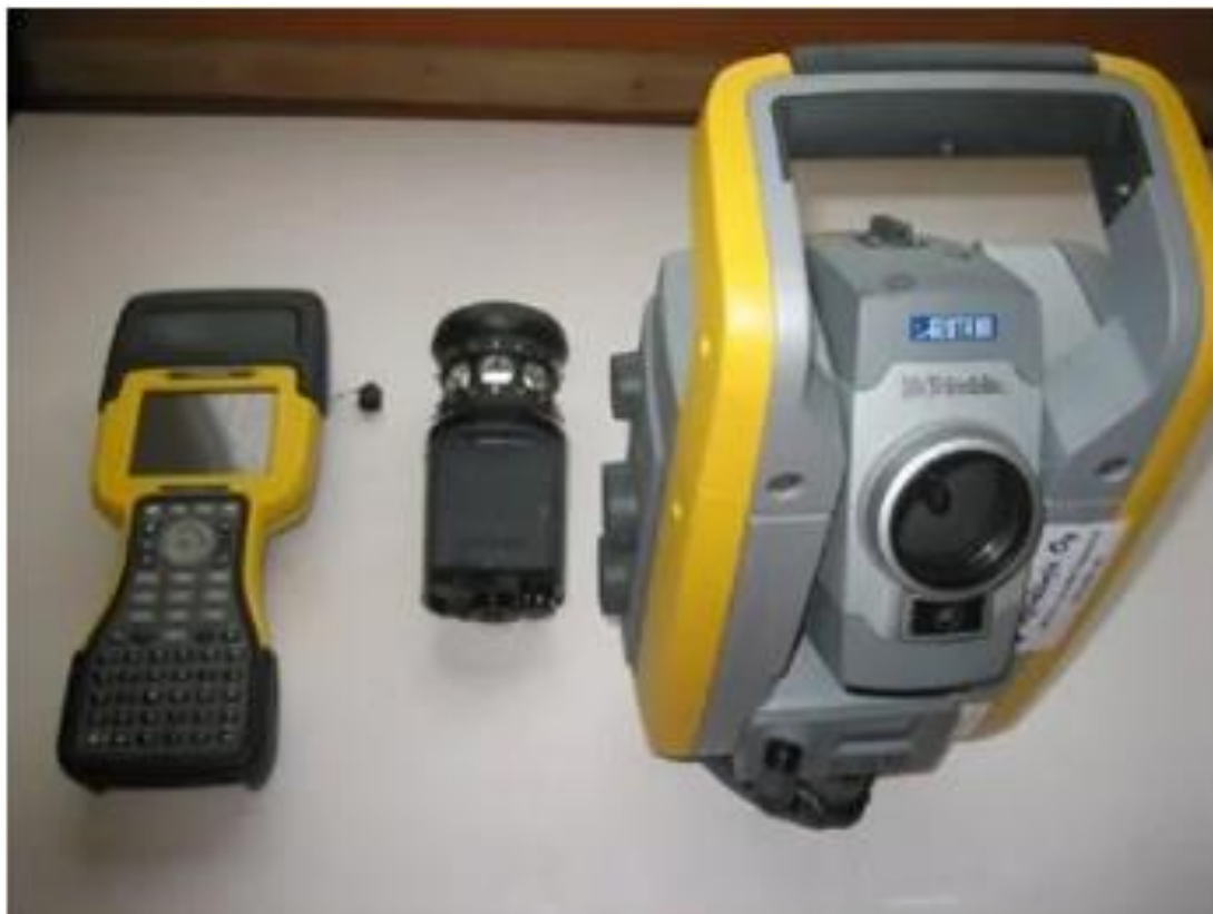
Kuva 5. Trimble TSC2 -maastotallennin, prisma ja Trimble S6 -robotitakymetri. (Infralinja Oy [Viitattu 27.03.2020])
