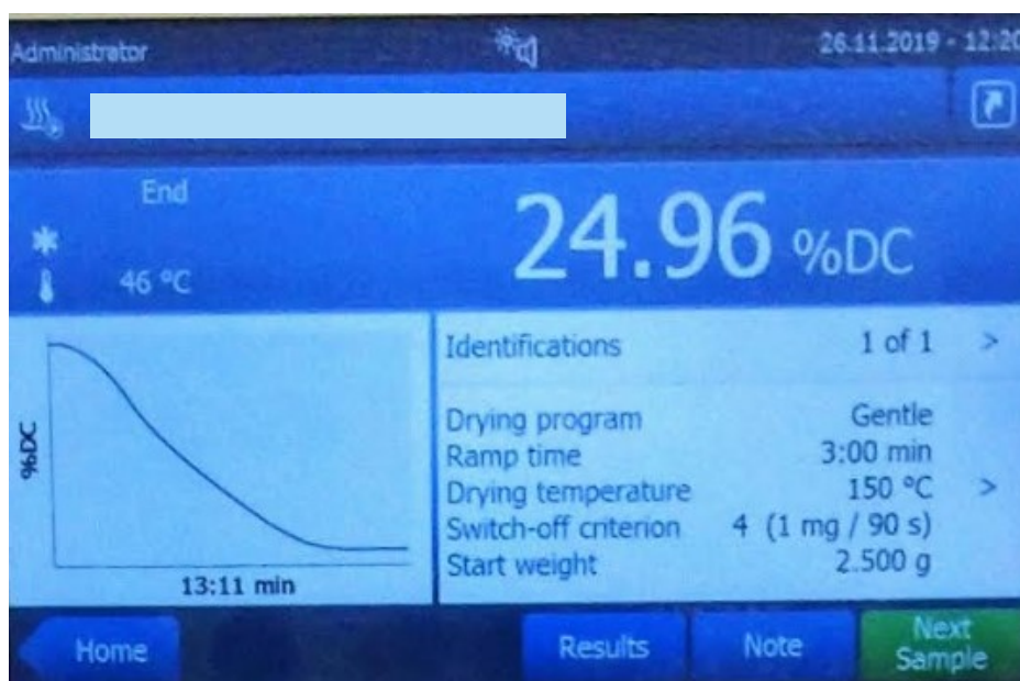
KUVA 4. Näkymä Excellence Plus HX204 halogeenikosteusanalysointilaitteen näytöstä kuiva-ainepitoisuusmäärityksen jälkeen
