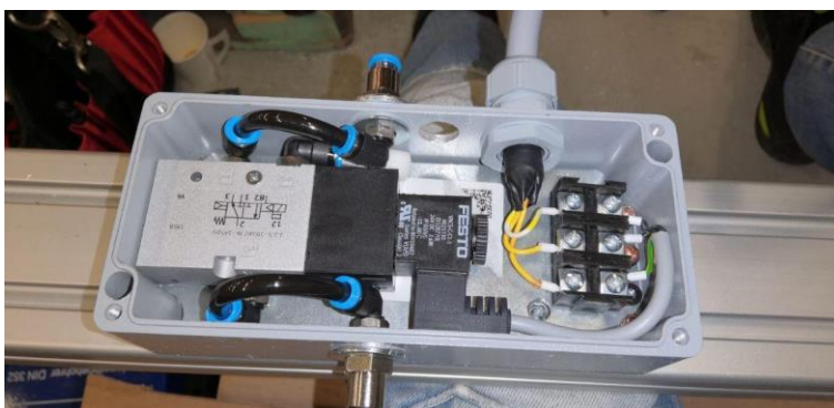
Kuva 11. Maalaustyökaluun integroitu ohjauskotelo komponentteineen.
