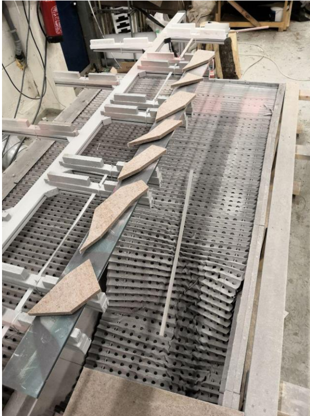
Kuva 13. Maalausteline korotuksien kanssa.
