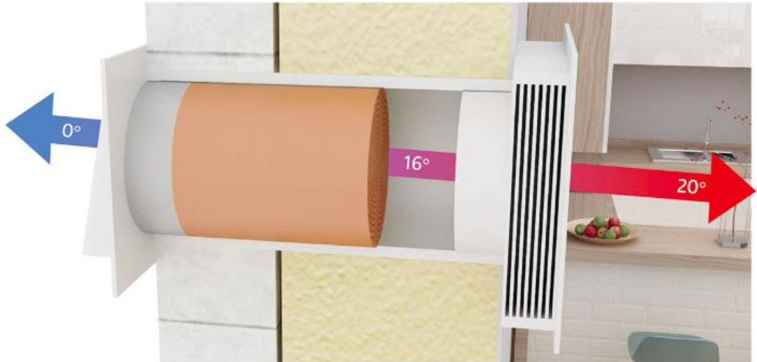
Kuva 4. Fresh Air Omega toimintaperiaate (SisäilmaCenter 2020 C)
