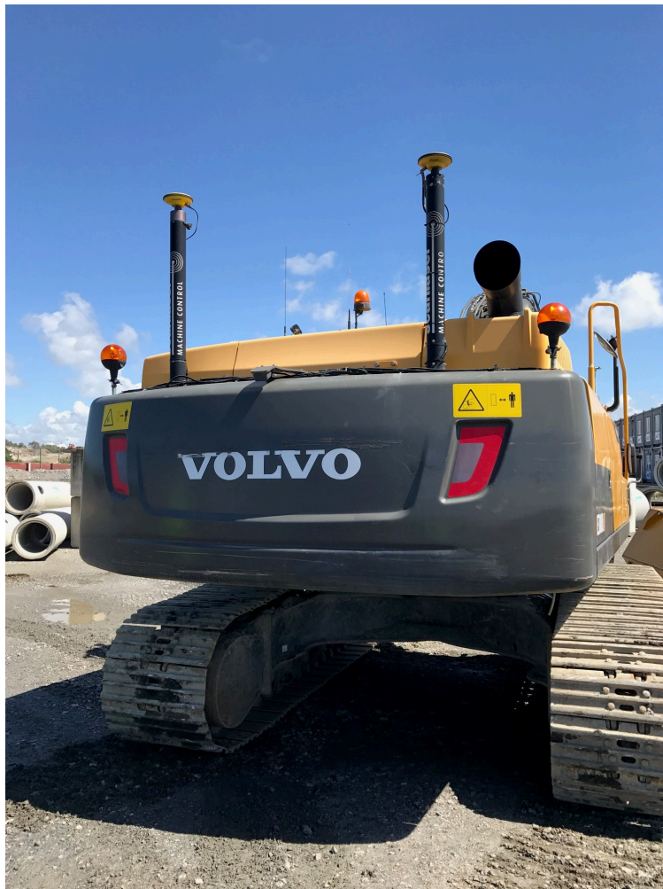
KUVA 3. Leican koneohjausjärjestelmä asennettuna kaivinkoneeseen.
