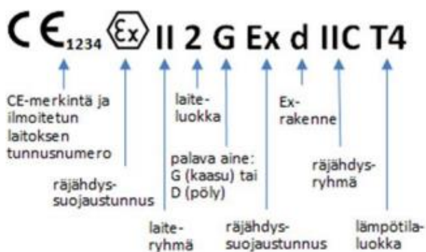
Kuva 2. Esimerkki Ex -laitteen merkinnästä (Tukesin www -sivut 2020.)
