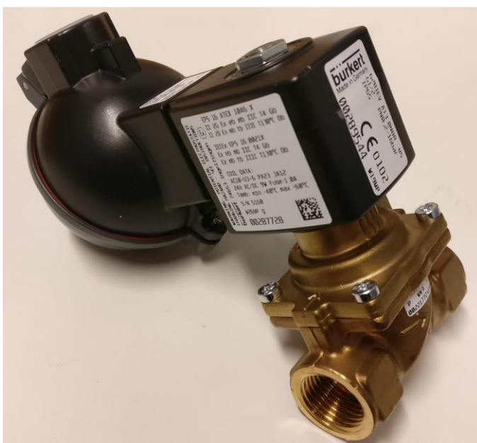
Kuva 7. Etanolilinjan magneettiventtiili 2G -laiteluokituksella.
