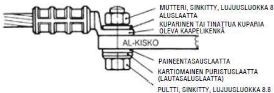
KUVA 33. Aluslaattojen käyttö kupari - alumiiniliitoksessa. (Mäkinen & Koivisto, 2020)
