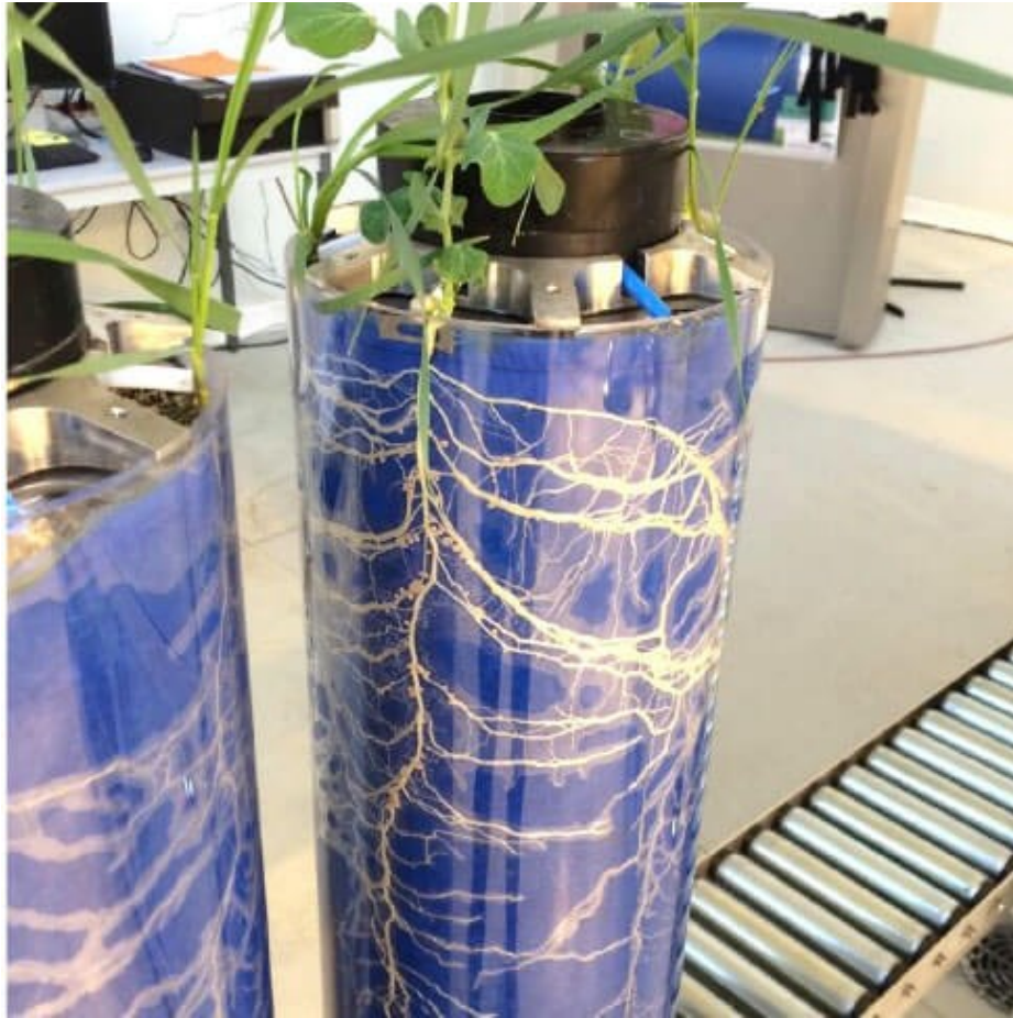
Kuva 12. Rhizotube-kasvatusalusta, jossa kasvualustan ja lasin välissä on kalvo. Siemen kylvetään kalvon ja lasin väliin. (Institut Carnot Plant2Pro n.d.)
