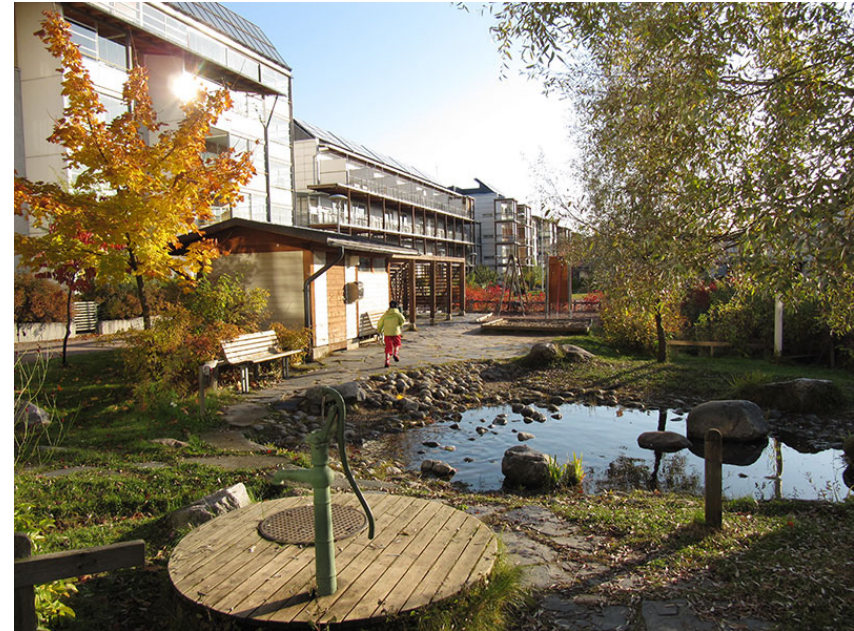
Kuva 12. Kuva Eko-Viikin alueelta. Kuvassa näkyvillä buleviesien viivytämiseen tarkoitettu sadeputarha. Asuinrakennusten katolla näkyvät aurinkolämpöjärjestelmien keräimiä. (Helsingin kaupunki)
