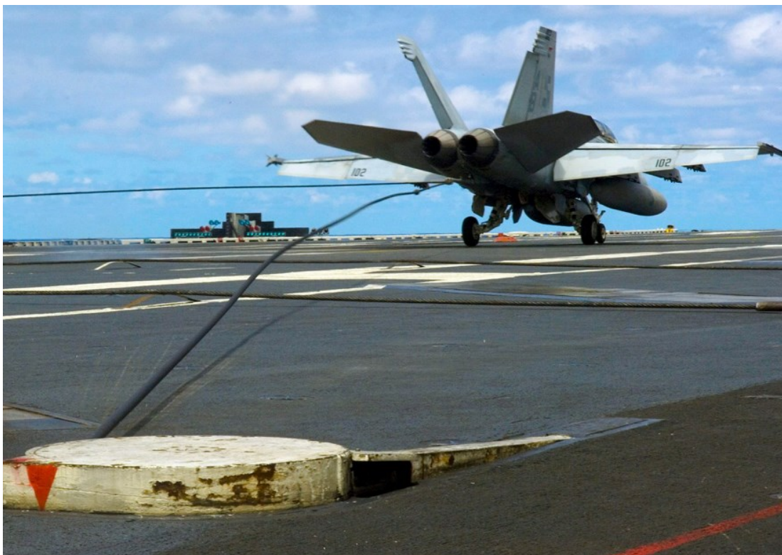
KUVA 6. USA:n merivoimien F/A-18F Super Hornet laskeutuu USS Enterprise (CVN 65) lentotukialuksen kannelle ja tarttuu koukullaan jarrutusvaijeriin. (Morris 2007)
