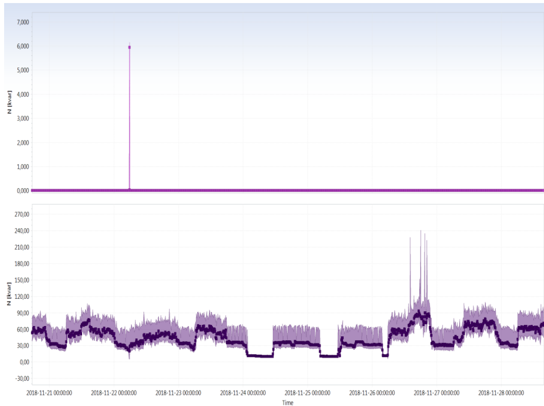
Kuva 22. Loisteho ajan funktiona (ylempi kapasitiivinen, alempi induktiivinen) 20.11. – 28.11.2018.
