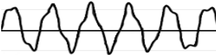
Kuva 6. Harmonisen yliaallon säröyttämän jännitteen kuvaaja.
