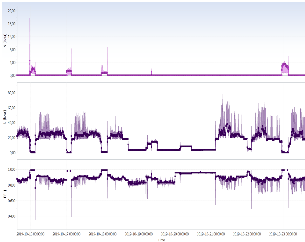
Kuva 11. JK-103:n kapasitiivisen ja induktiivisen loistehon arvot, sekä tehokerroin PF ajan funktiona.
