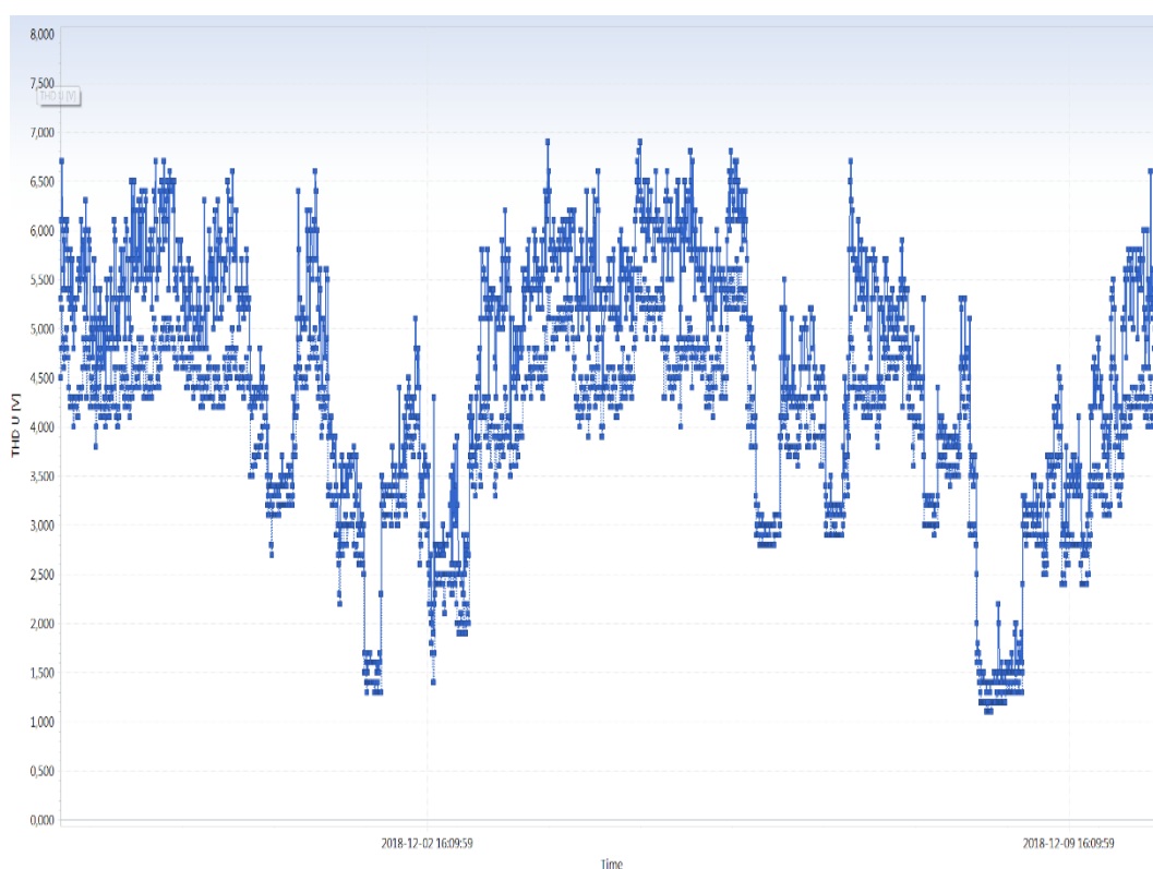
Kuva 36. L1-vaiheen THD voltteina ajan funktiona 28.11. – 10.12.2018.
