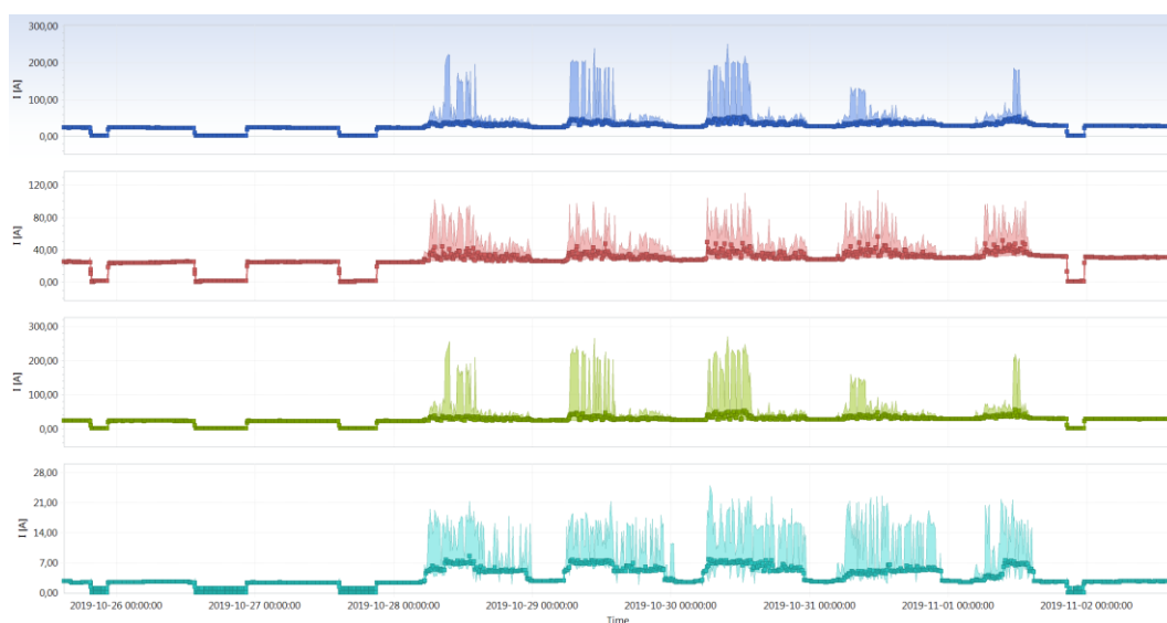
Kuva 56. Vaiheiden L1, L2, L3 ja LN virran arvot ajan funktiona 25.10. – 2.11.2019.
