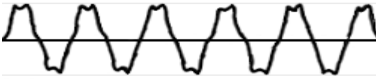
Kuva 6. Harmonisen yliaallon säröyttämän jännitteen kuvaaja.
