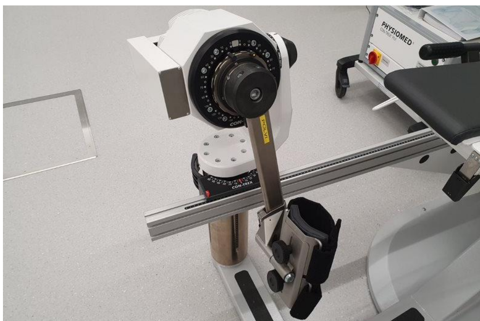
Kuva 4. Varsinainen dynamometri, johon on liitettyä polven testaamiseen tarkoitettu adapteri
