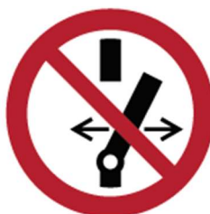
Kuva V.2 Kieltoerkki: Kytkimen asennon muuttaminen kielletty (ISO 7010-P031)
