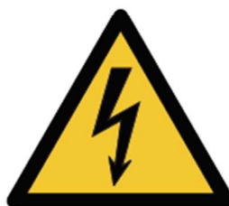
Kuva V.1 Varoituserkki: Vaarallinen jännite (ISO 7010-W012)
