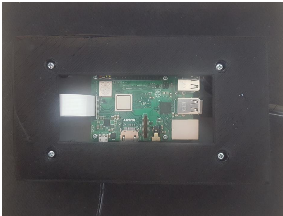
Kuva 9: Raspberry Pi -tietokone 3D-tulostetussa suojakotelossaan.
