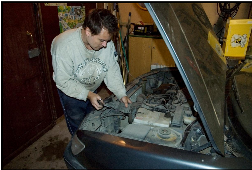
Kuvaliite 2. Imuilmaputken asennusta
