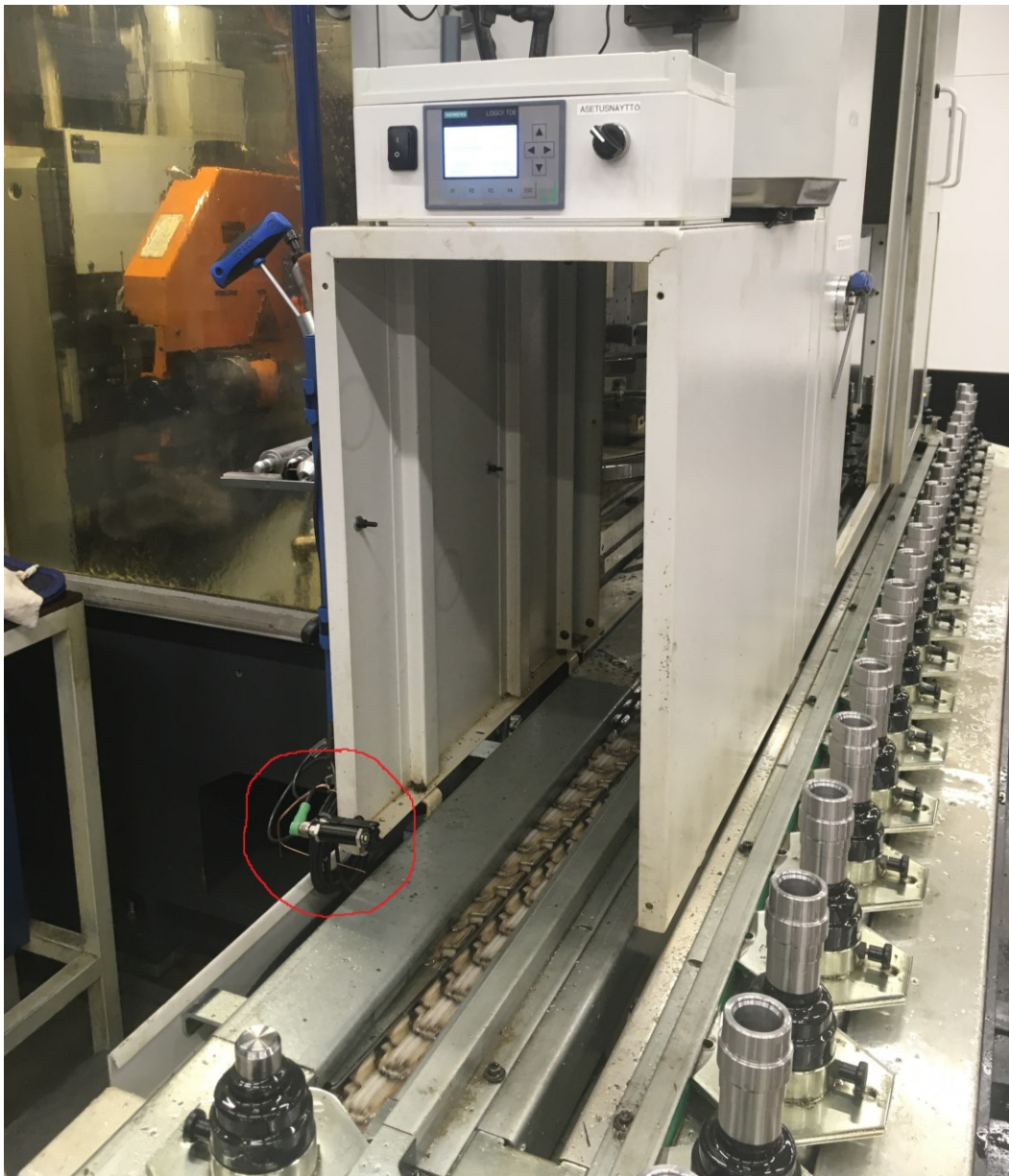
KUVA 21. Laskijalaite Liebherr LC 80 -vierintäjäyrsinkoneella, ultraäänianturi ympyröitynä
