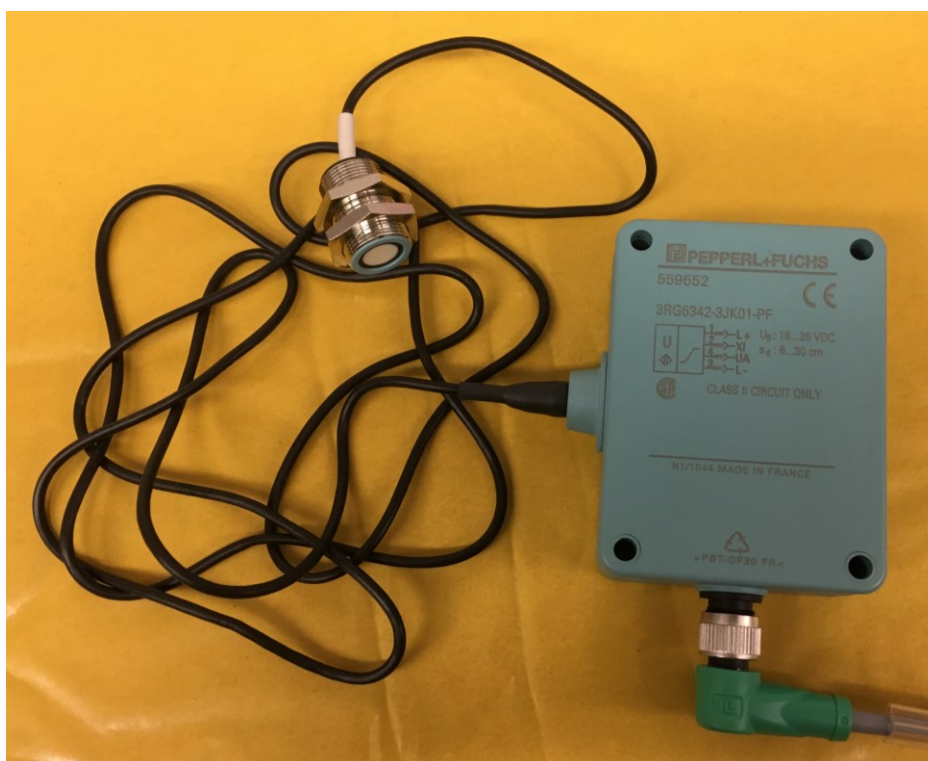
KUVA 4. PEPPERL+FUCHS -ultraäänianturi elektroniikkarasioineen
