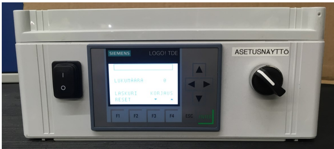
KUVA 14. Laskijalaite koottuna ja käyttövalmiina
