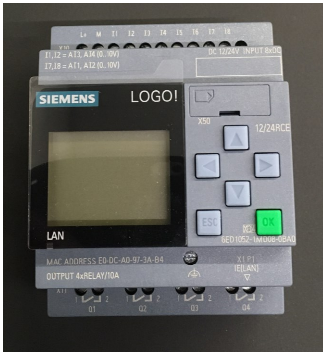
KUVA 8. Siemens LOGO! 12/24 RCE -logiikkamoduli
