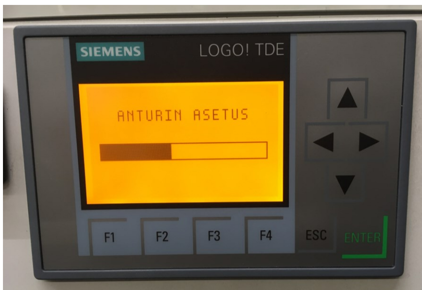
KUVA 18. Asetusnäyttö, kappale havaittu ja laskentakynnys ylitetty
