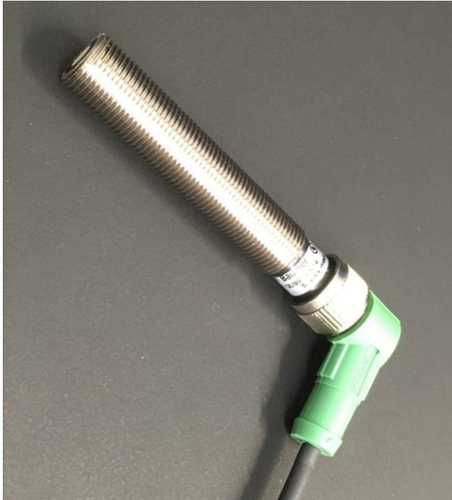
KUVA 6. Baumer UNAM 12U9914/S14 -ultraäänianturi liitäntäkaapeleineen
