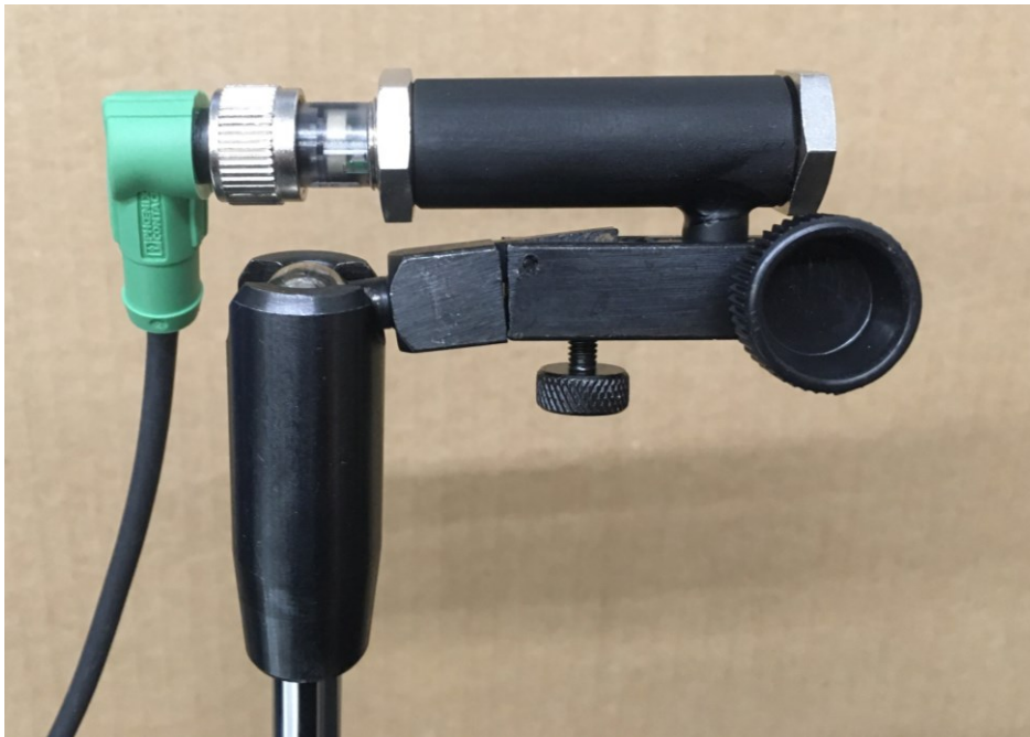
KUVA 10. Ultraäänianturin kiinnityskappale mittakellon jalkaan kiinnitettynä. Anturi kuvassa kiinnityskappaleen sisällä suojassa.
