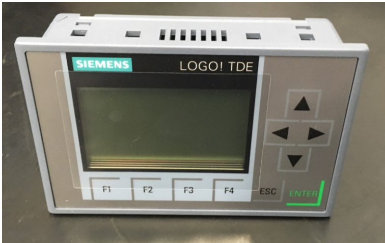
KUVA 7. Siemens LOGO! TDE -tekstinäyttö
