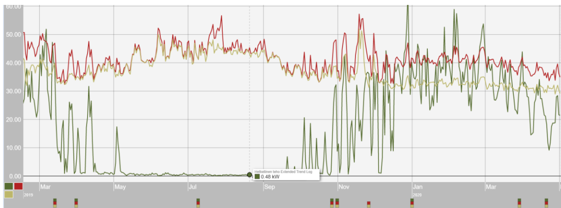
KUVIO 57. Lämmitysjärjestelmän meno- ja paluulämpötila sekä lämpöpumppujen verkostoon tuottama teho
