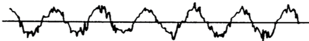
Kuva 26. Signaalijännite summautunut verkon perusaaltoon (ABB:n TTT-käsikirja 2000-07. Luku 4, 5)
