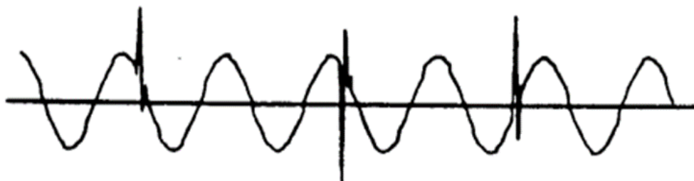
Kuva 22. Transienttiylijännite (ABB:n TTT-käsikirja 2000-07. Luku 4, 4)
