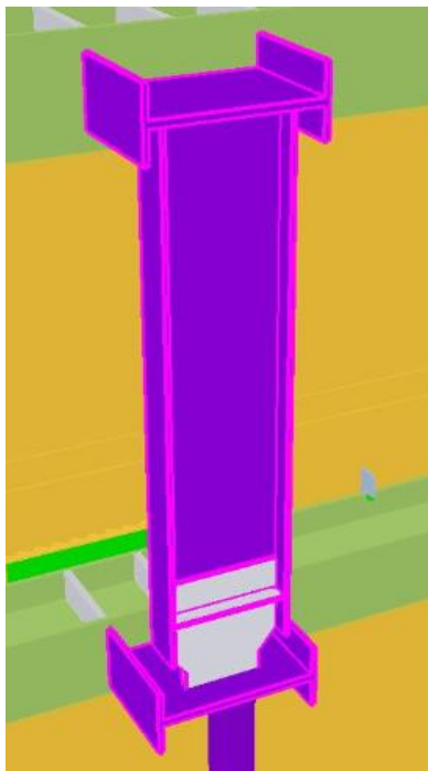
KUVA 9. Pystysuuntainen kattilaohjuri ja ohjurihaarukat
