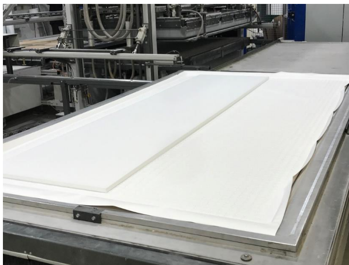
KUVA 10. Elementti leikattavana leikkauspaikalla (Mikkonen 2020)
